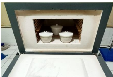
Gambar 6. Proses Aktivasi Secara Kimia Karbon Pelepah Enceng Gondok pada Suhu 750^{\circ}\text{C} Selama 2 Jam
