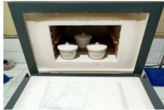
Gambar 3. Potongan bahan baku pelelah enceng gondok dimasukkan dalam furnace untuk proses karbonisasi.
