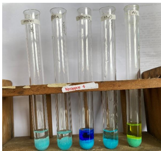
Gambar 2. Hasil Uji Kelarutan Kristal Cu(NH 4 ) 2 (SO 4 ) 2 ·6H 2 O.
